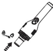
Po czyszczeniu zainstalować filtry i zbiornik na kurz z powrotem w głównej obudowie.
