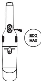
Cihazı açmak için güç anahtarına basın ve kapatmak için tekrar basın. Cihazı MAX veya ECO moduna almak için ECO/MAX düğmesine basın.
