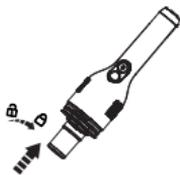
Après le nettoyage, réinstallez les filtres et le bac à poussière dans le corps principal.
