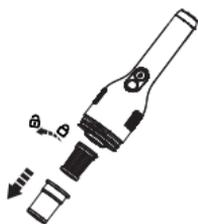
Als de stofbak niet is geïnstalleerd, draait u tegen de wijzers van de klok in om het gaasfilter te verwijderen.
