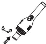
Después de limpiarlos, vuelva a instalar los filtros y el depósito de polvo en el cuerpo principal.
